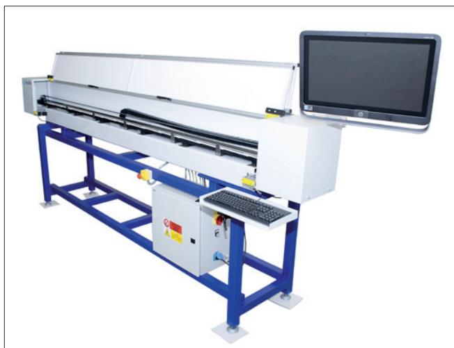
Obr. 1. Jednoúčelový stroj pro optickou kontrolu vyrobených skládacích metrů
