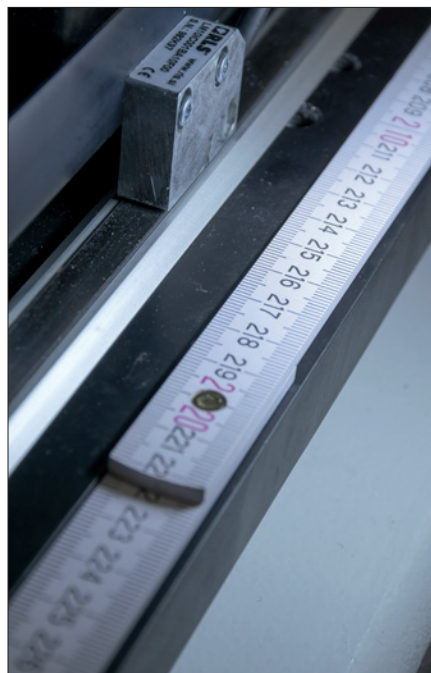
Obr. 3. Poloha vozíku je měřena magnetickým snímačem délky
