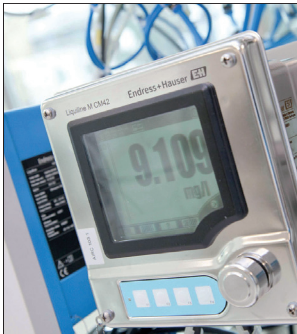
Obr. 1. Převodníky Liquiline jsou určeny pro snímače chemických a fyzikálních vlastností kapalin, analyzátoři a vzorkovače
