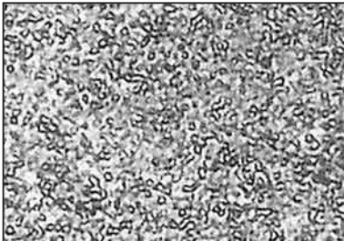
Feinstkorn-Hartmetall-Kornstruktur Ultra-Micro-Grain, Korngrößen 0–0,5 µm Finegrain-hardmetal structure Ultra-micro-grain, grain size 0–0.5 micron
